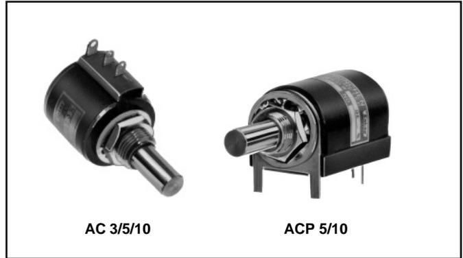
Die Serie Dynapot findet ein breites Anwendungsfeld in der industriellen Elektronik und Elektromechanik. Durch eine spezielle Schleiferkonstruktion unter Verwendung massiver Edelmetall-Kontakte erfüllt diese Serie auch hohe Erwartungen an Zuverlässigkeit und Lebensdauer. Eine präzise Mechanik in Verbindung mit einer doppelten Achslagerung erlaubt die Anwendung auch in Nachlaufsystemen und Motorpotentiometern.
